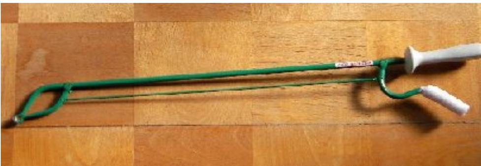
磁石で床に落ちた物をとる道具です。レバーを握ると口が開閉します。
